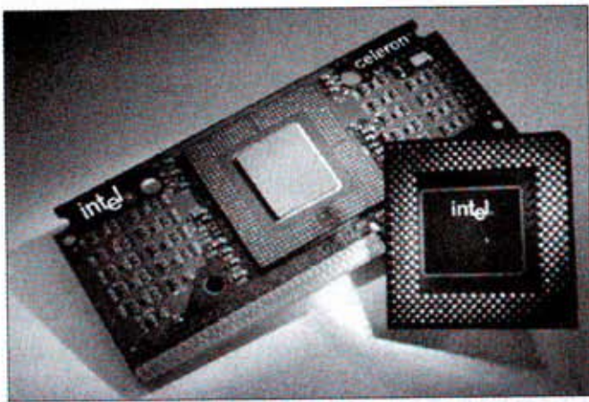
Intel ၏ Celeron ပရိုဆက်ဆာသည် SEC package ဖြင့် ပထမဦးဆုံးထုတ် လုပ်သည့် ပရိုဆက်ဆာမျိုးဖြစ်သည်။ သို့သော် နောက်ပိုင်းတွင် Socket 370 ဌာတပ်ဆင်နိုင်ရန်အတွက် PGA ချစ်ပ် အနေဖြင့်လည်း ထုတ်လုပ်လာသည်
