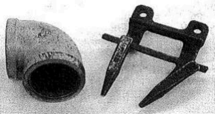
ပုံ ၃ - ၂။ Malleable Cast Iron ဖြင့် ပြုလုပ်ထားသည့် ပစ္စည်းများ
