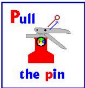
၁။ လက်ကိုင်အနီးရှိ သော့ချထားသော ပင်ကို ဆွဲနှုတ်ပါ။ (Pull the Pin)
