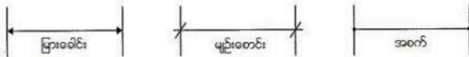
ပုံ ၄ - ၇။ အတိုင်းအတာမျဉ်း၏ အဆုံးပုံစံ အမျိုးမျိုး
